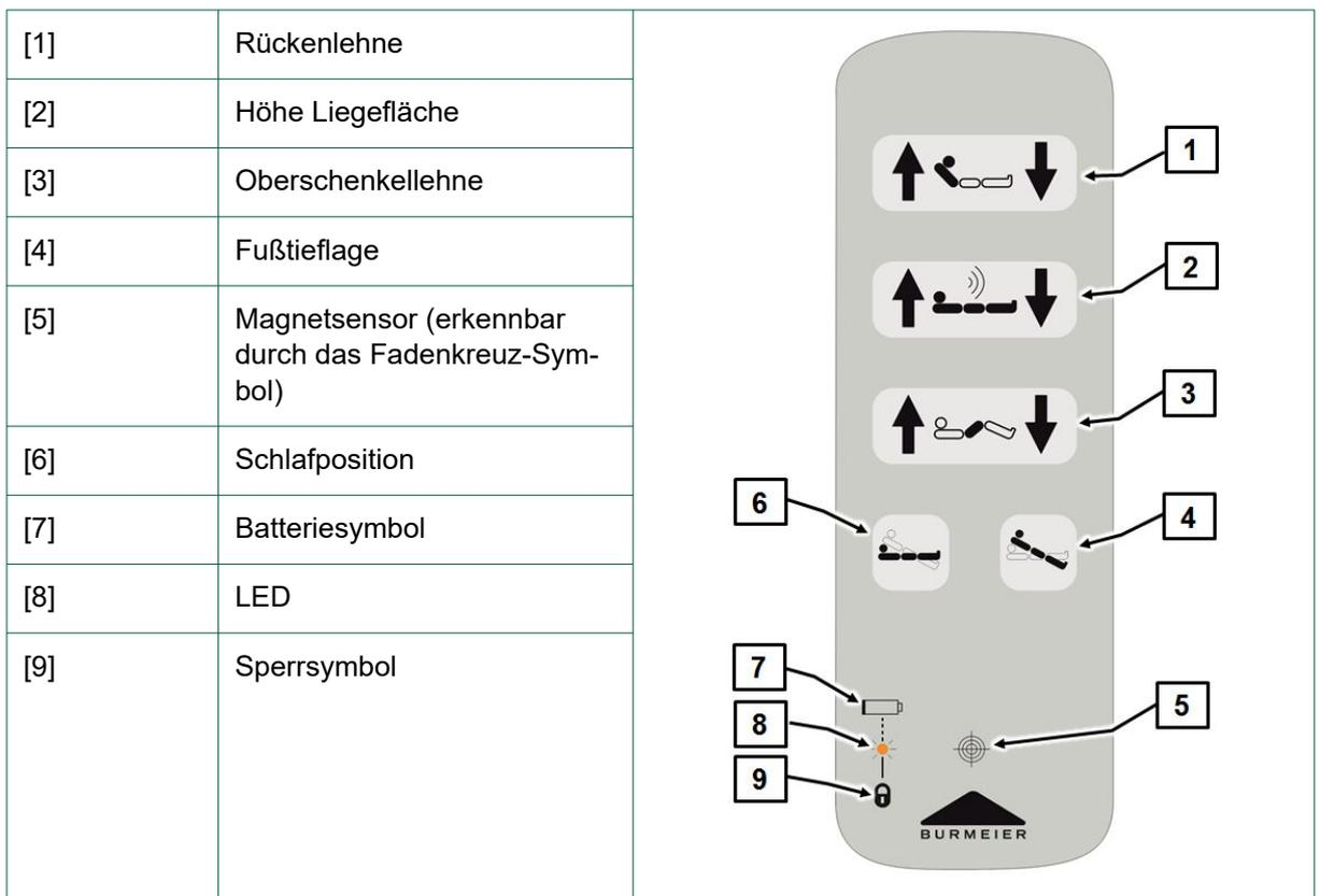
**i** Fahren Sie die Liegeflächenhöhe bei Bedarf jedoch mindestens 1 mal täglich in die obere oder untere Endlage. Hierdurch ermöglichen Sie einen automatischen Ausgleich der beiden unabhängigen Verstellantriebe und somit eine waagerechte Liegefläche.
