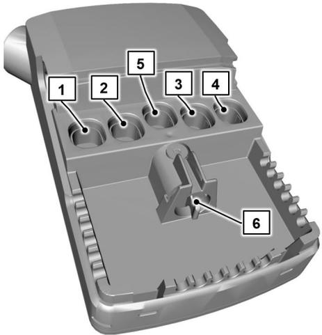
**i** Beachten Sie bitte: Um einen falschen Anschluss der Hubmotoren zu vermeiden, sind die Kabel des kopfseitigen sowie des fußseitigen Hubmotors jeweils mit einer Nummer versehen (die 2 für den kopfseitigen Hubmotor und die 4 für den fußseitigen Hubmotor). Diese Nummern finden sich an den Verbindungsleitungen der Hubmotoren entsprechend wieder. Achten Sie darauf, die Nummern an den Kabeln mit den Nummern an den Hubmotoren zu vergleichen, bevor Sie sie anschließen.
