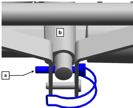
3. Die zweite Pflegekraft entfernt nun den Sicherungssplint [a]. Schwenken Sie dafür den gebogenen Bügel weg und ziehen den Sicherungssplint mitsamt dem Bügel aus der Hubstange des Rückenlehnenmotors [b] heraus.
