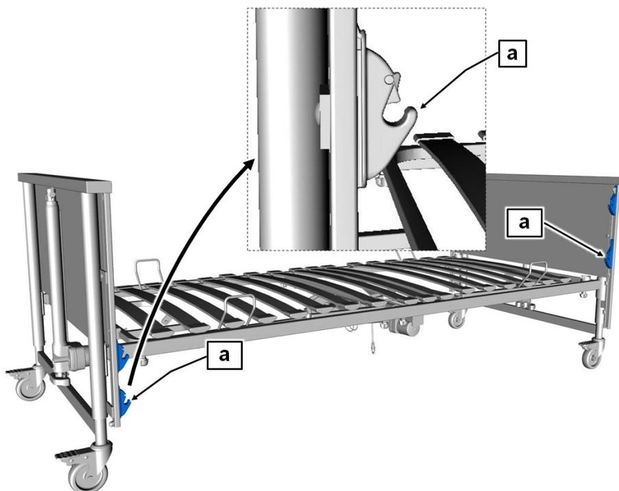
**Wichtig:** Die Führungsschienen müssen vor Beginn der Montagearbeiten diagonal zueinander stehen (siehe Bild). Stellen Sie hierfür die kopfseitige Führungsschiene hoch, und senken Sie die fußseitige Führungsschiene ab.
